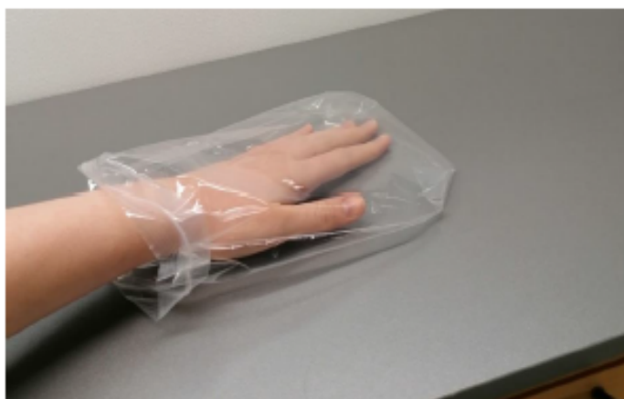
Kuva 1. Pölynäytteen ottaminen nurinpäin käännetyllä muovipussilla
