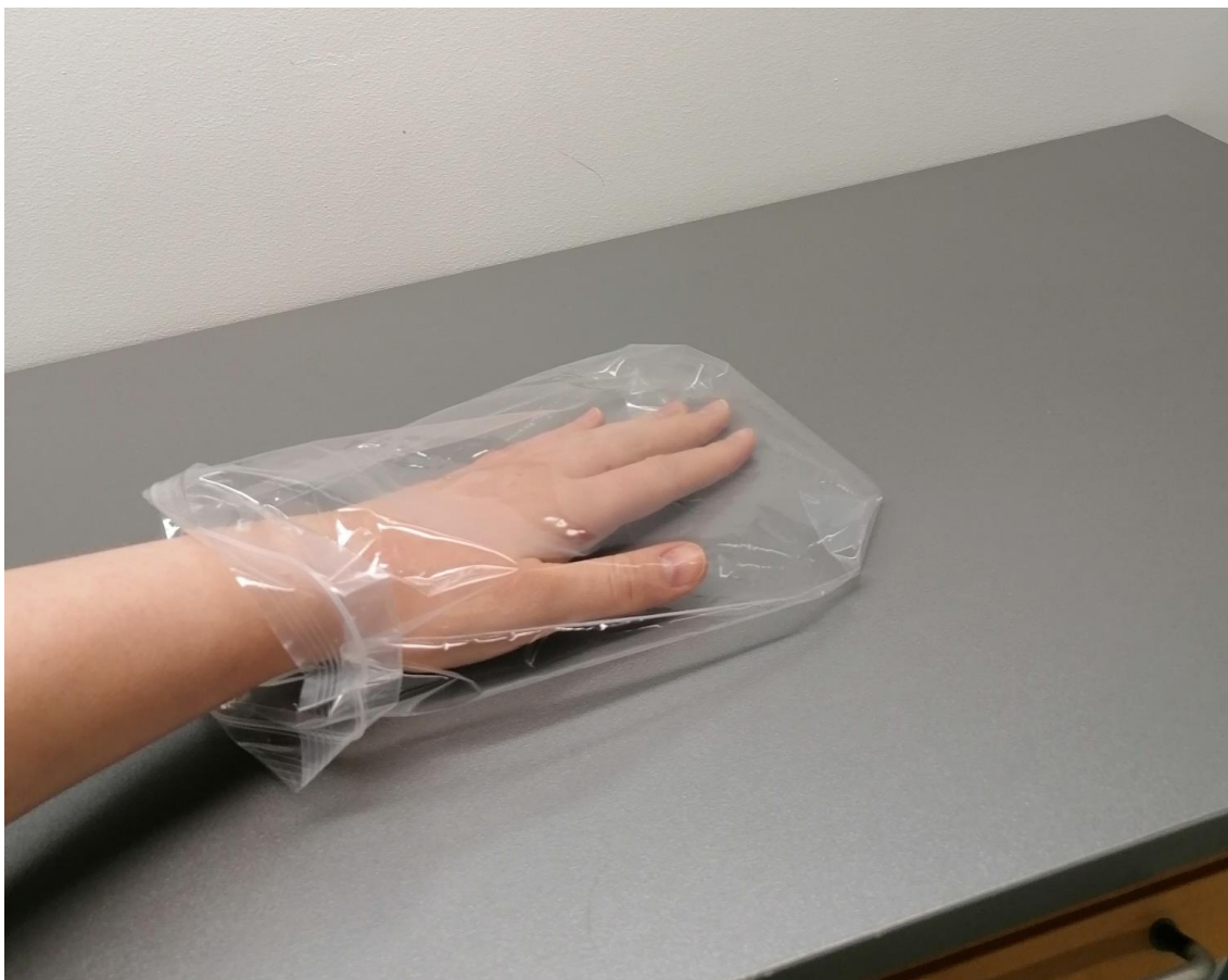
KUVA 2. Pölynäytteenotto nurinpäin käännetyllä muovipussilla
