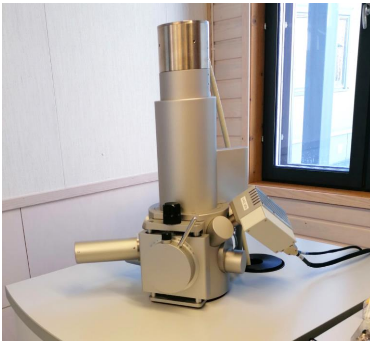
KUVA 4. Tescan Vega 3 -pyyhkäisyelektronimikroskoopin elektronikolonne
