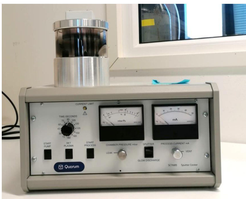
KUVA 8. Ohutkalvopinnoitukseen käytettävä Quorum SC7620 Sputter Coater
