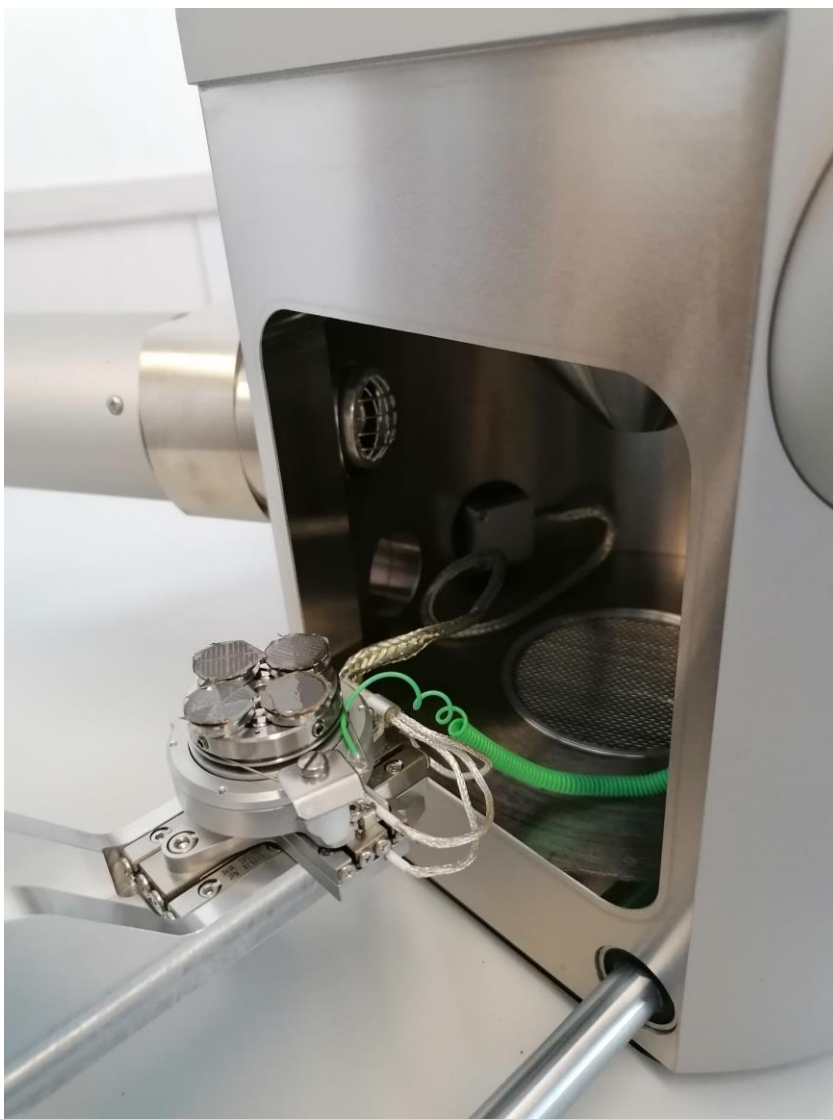
KUVA 7. Elektronimikroskoopin näytekammio ja näytejalusta, johon kiinnitetty neljä näytettä
